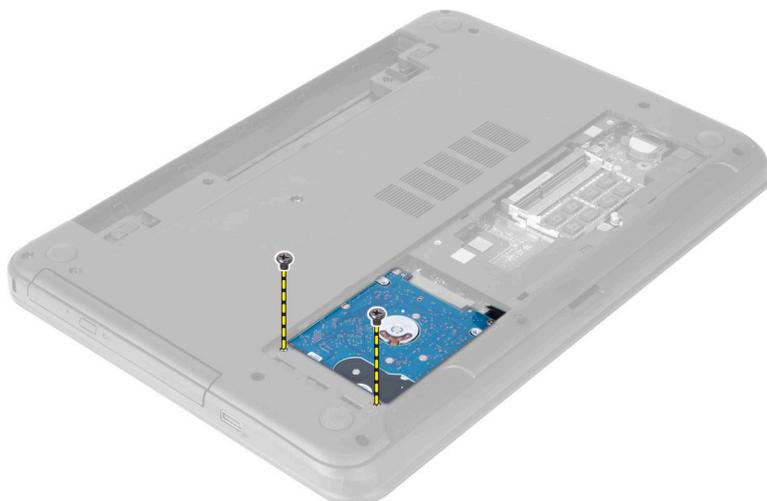
4. Deslize a unidade de disco rígido na direcção mostrada e levante a patilha para retirá-la do computador.
