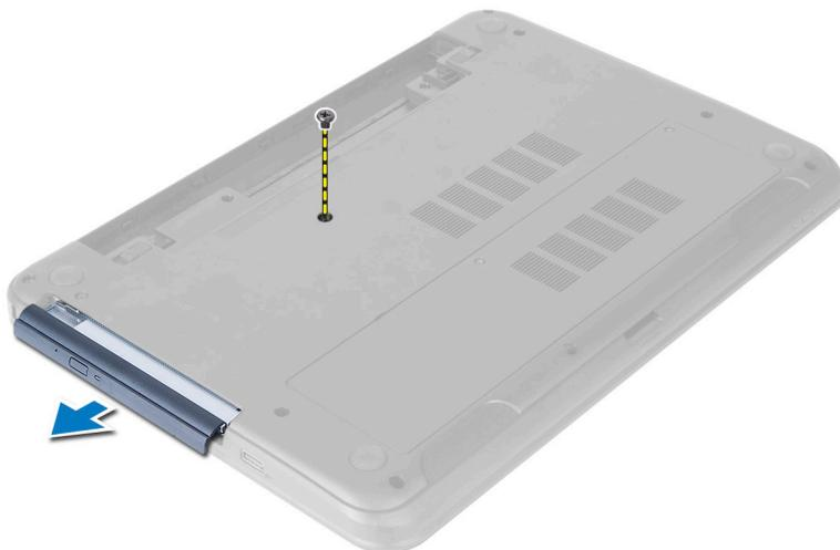
4. Retire os parafusos que fixam o suporte da unidade óptica ao conjunto da respectiva unidade.
